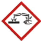
Danger de corrosion
